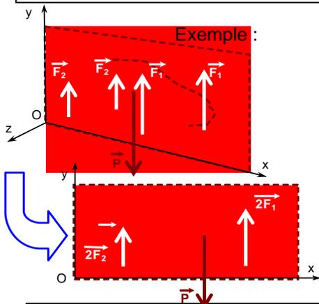
Pour un système plan parallèlement au plan (O,  $\vec{x}, \vec{y}$ ), tous les torseurs ont **leurs composantes Z, L et M nulles** :
