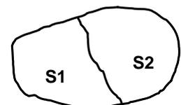
S en équilibre  $\Rightarrow \{T_{\bar{S} \rightarrow S}\} = \{0\} \Rightarrow \{T_{\bar{S} \rightarrow S1}\} + \{T_{\bar{S} \rightarrow S2}\} = \{0\}$  (1)
