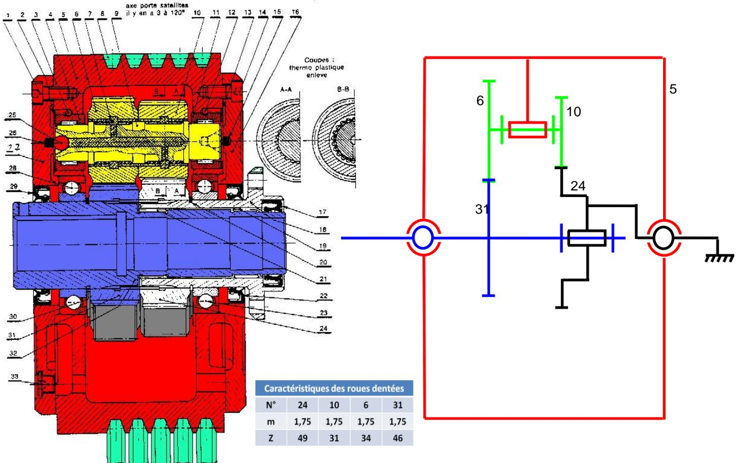
Le mouvement d'entrée est reçu par le boîtier tournant 5, entraîné par cinq courroies trapézoïdales 8, et guidé en rotation par rapport au bâti 18 à l'aide de deux roulements à billes 23 et 28.
