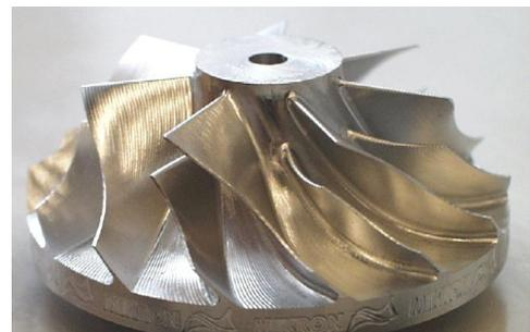
Exemple de pièce complexe obtenue par usinage
