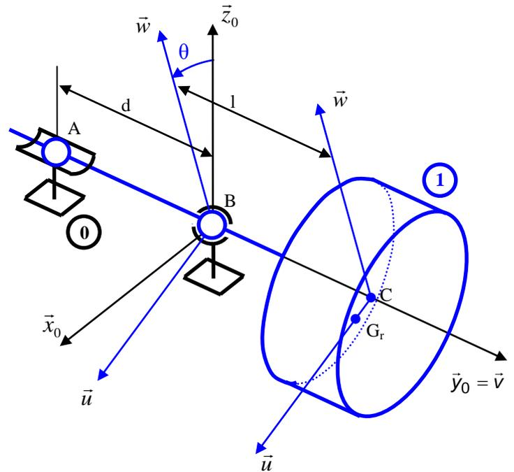
On définit le repère  $(O, \vec{x}_0, \vec{y}_0, \vec{z}_0)$  lié au bâti 0 et le repère  $(O, \vec{u}, \vec{v} = \vec{y}_0, \vec{w})$  lié au rotor 1. On pose  $\theta = (\vec{x}_0, \vec{u})$  tel que  $\dot{\theta} = \omega.t$  avec  $\omega = \text{constante}$ .
