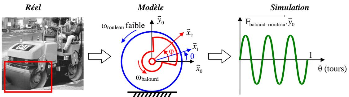
Par contre, dans la plupart des applications où des solides sont entraînés en rotation, ces forces tournantes sont indésirables car elles provoquent des vibrations nuisibles. Celles-ci peuvent engendrer une détérioration rapide des liaisons ainsi qu'une gêne pour l'utilisateur du matériel. Pour supprimer ces vibrations dues aux masses mal réparties, on réalise un **équilibrage**. Cet équilibrage est d'autant plus nécessaire que la vitesse de rotation est grande.
