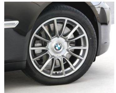
Lorsqu'un solide est entraîné en rotation autour d'un axe fixe et qu'il possède une mauvaise répartition de matière autour de cet axe, l'application du Principe Fondamental de la Dynamique permet de montrer que des forces centrifuges tournantes s'exercent sur ce solide.
