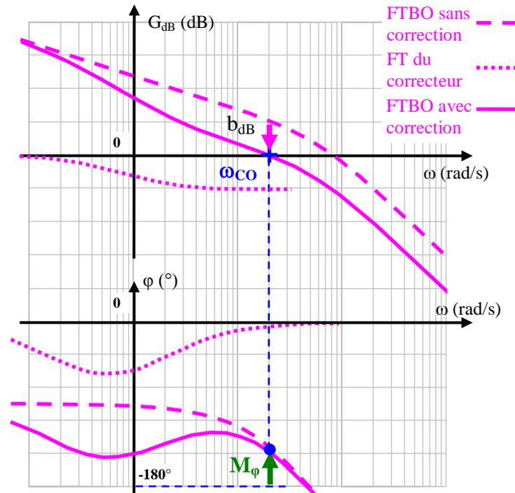
Si la FTBO ne possède pas d'intégration, l'écart de position ne sera pas nul. Il faudra prévoir soit un intégrateur dans la correction, soit un gain suffisant.
