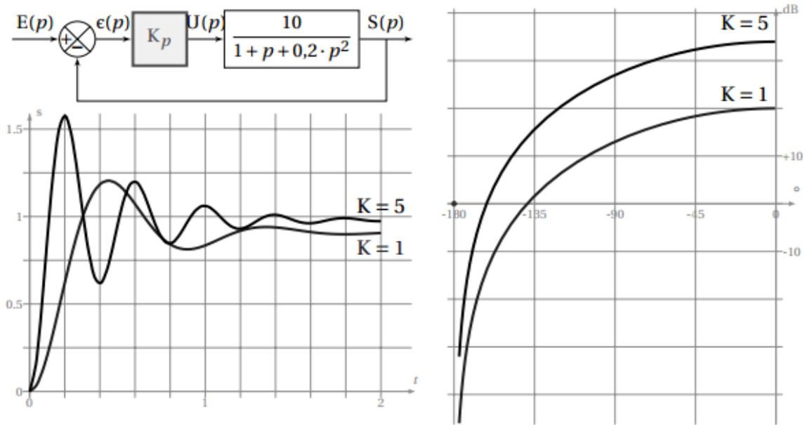
Réglage d'un correcteur proportionnel vis-à-vis de marges de stabilité imposées
