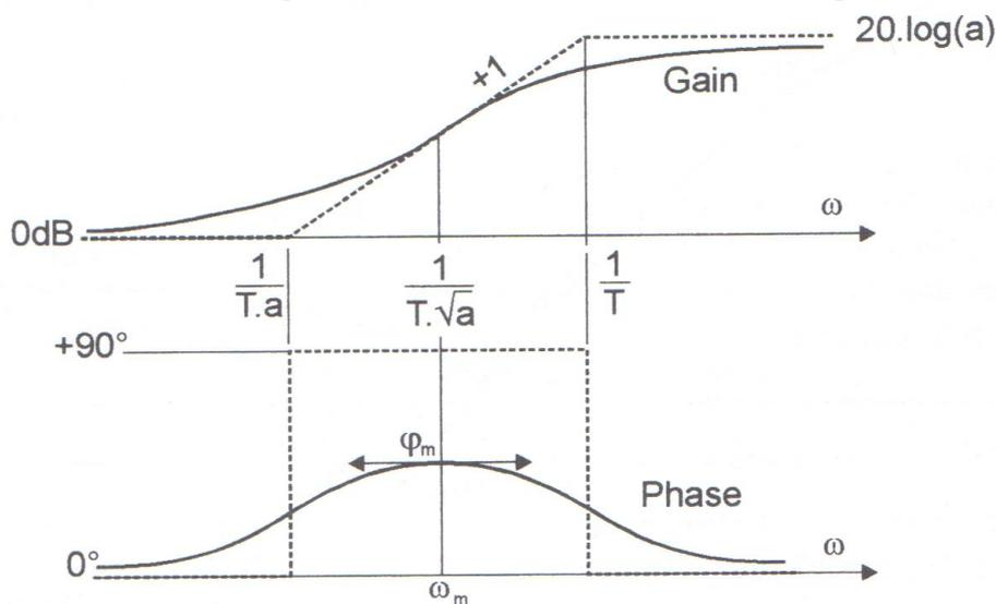
Diagrammes de BODE d'un correcteur PD réel (avec  $K_p=1$ )
