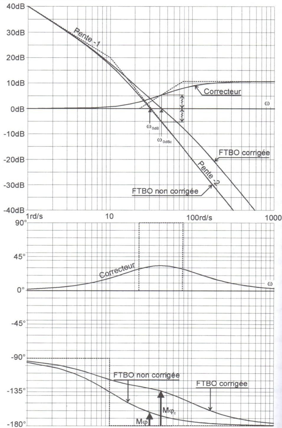
Si la FTBO ne possède pas d'intégration, l'écart de position ne sera pas nul. Il faudra prévoir soit un intégrateur dans la correction, soit un gain suffisant.
