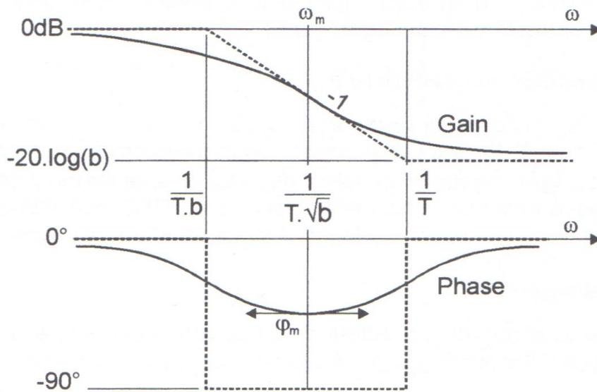
La phase passe par un minimum  $\varphi_{\min}$  tel que  $\varphi_{\min} = \text{Arcsin} \frac{1-b}{1+b}$  pour la pulsation  $\omega_m = \frac{1}{\tau_i \cdot \sqrt{b}}$
