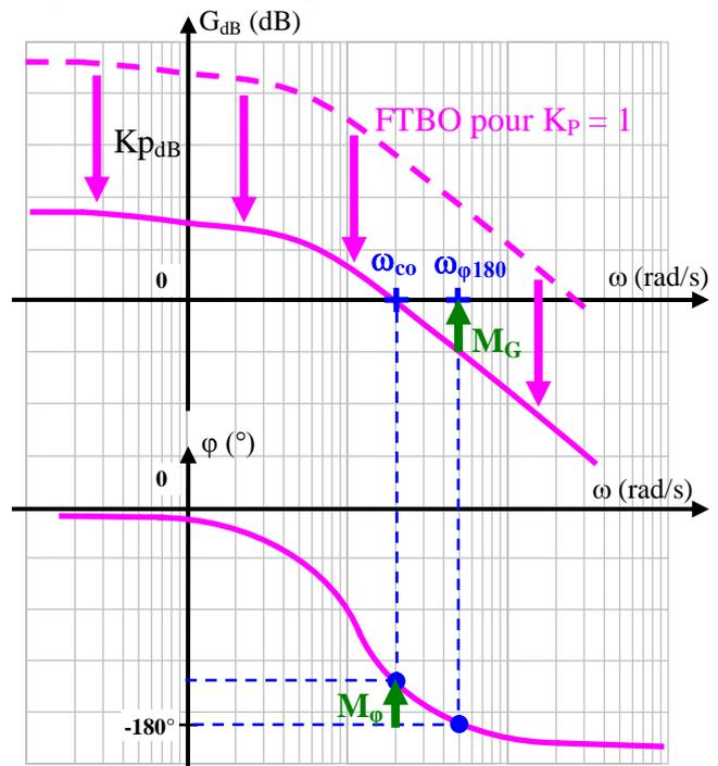
Réglage d'un correcteur proportionnel vis-à-vis d'une précision imposée
