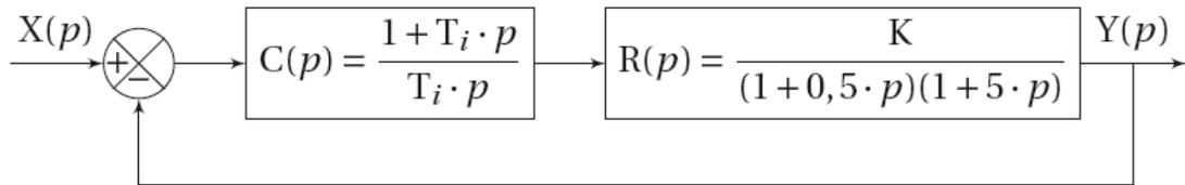
**Q1.** A partir du critère de Routh déterminer à quelles conditions sur  $K$  et  $T_i$  le système est stable.
