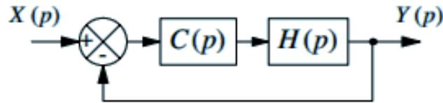
La fonction de transfert  $H(p)$  est de la forme :  $H(p) = \frac{a}{(1 + T_1 \cdot p)(1 + T_2 \cdot p)}$
