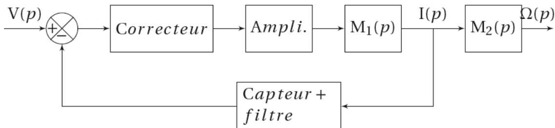
Le capteur de courant dans la boucle de retour est une sonde à effet Hall associée à un filtre pour atténuer les ondulations du courant dues à la MLI (Modulation de Largeur d'Impulsions). La fonction de transfert de cet ensemble est donnée par  $R(p) = \frac{k}{(1+T_f p)}$  avec  $T_f = 0,5 \text{ ms}$ . L'amplificateur de puissance possède un gain
