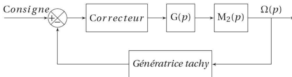
La génératrice tachymétrique est modélisée par une transmittance constante de  $K_t = 0,1 \text{ V/rad/s}$ . La fonction de transfert du correcteur est notée  $C_v(p)$ . On prendra  $C_v(p) = K_v$  (correcteur proportionnel).
